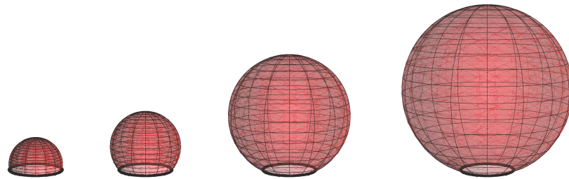
Abbildung 4.6: Einige Membrane, die sich nicht durch (x, y, u(x, y)) parametrisieren lassen; f ist gleich 1.4, 1.2, .8 und .6. Wie man erwarten sollte: Kugeloberflächen.
