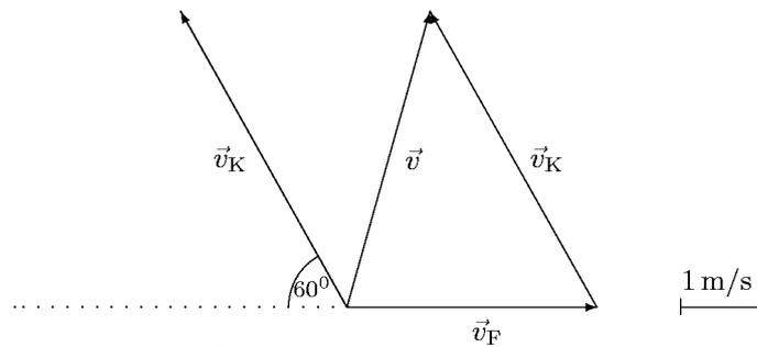
Nun kann man Richtung und Länge von  $\vec{v}$  aus einer sauberen Zeichnung entnehmen. Die obige Zeichnung ergibt z. B. eine Geschwindigkeit von etwa  $3,7 \text{ m/s}$  unter einem Winkel von etwa  $75^\circ$  mit der Fließrichtung des Flusses. (Bemerkungen zur rechnerischen Bestimmung dieser Größen siehe unten.)
