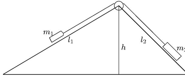
$h = 2,4$  m und Längen  $l_1 = 4$  m sowie  $l_2 = 3$  m. Auf ihr liegen zwei Metallquader von  $m_1 = 800$  g und  $m_2 = 500$  g Masse, die durch ein Seil über eine Rolle miteinander verbunden sind. Die Reibung der Rolle kann vernachlässigt werden, nicht jedoch die auf der schiefen Ebene.
