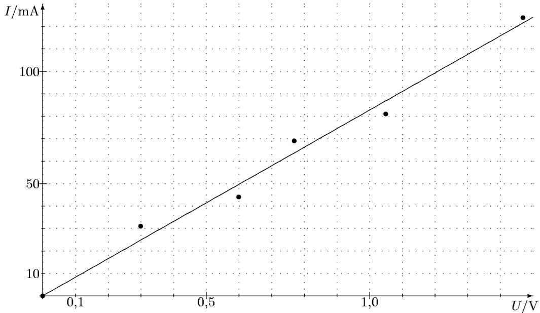
[Ergänzung: Aus der Zeichnung kann man bei  $U = 100 \text{ mV}$  etwa  $I = 1,2 \text{ A}$  ablesen und damit einen Widerstand von  $12 \Omega$  ermitteln. Alternativ erhält man durch Mitteln der Widerstände der einzelnen Messpunkte einen Widerstandswert  $12,46 \Omega$ .]
