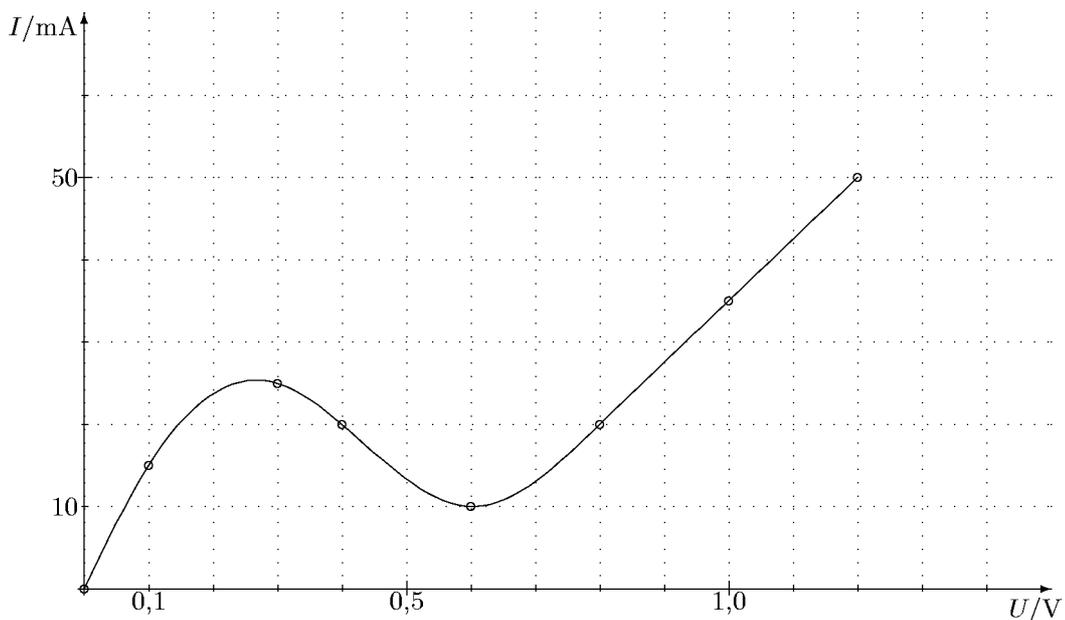
b) Bei der Tunnelodiode gilt das Ohmsche Gesetz nicht. Es gilt nicht einmal, dass die Stromstärke in Abhängigkeit von der Spannung monoton wächst, insbesondere kann keine Proportionalität bestehen.
