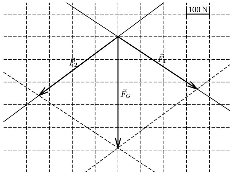
Durch Ausmessen bestimmt man die Beträge  $F_1$ ,  $F_2$  der so ermittelten Kraftvektoren und damit die Belastungen der Seile:
