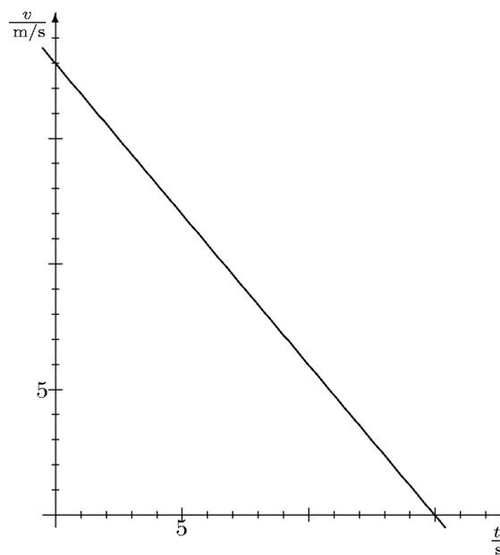
b) Der Bremsweg ist die Fläche unter der Geschwindigkeits-Zeit-Kurve und beträgt
