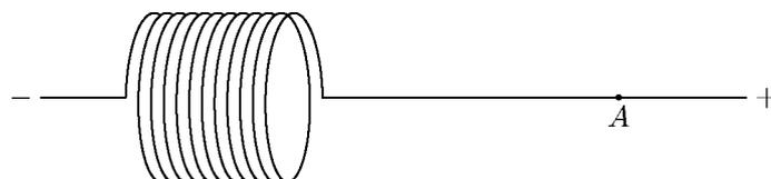
c) Eine schlanke Spule habe  $n = 2000$  Windungen und die Länge  $l = 25$  cm. Bestimmen Sie die magnetische Flussdichte in ihrem Innern, wenn sie von einem Strom der Stärke  $I = 10$  A durchflossen wird. Was geschieht, wenn man einen ferromagnetischen Stoff in die Spule einführt?
