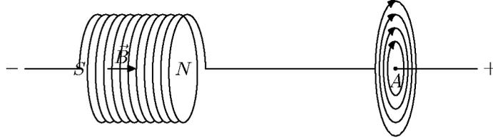
c) Das von einer stromdurchflossenen Spule erzeugte Magnetfeld im Innern wird durch die magnetische Feldgleichung gegeben:
