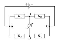
Bei einer Spannung U = 60 V fließe kein Strom durch das Amperemeter. Bestimmen Sie den Widerstand  $R_4$ .
