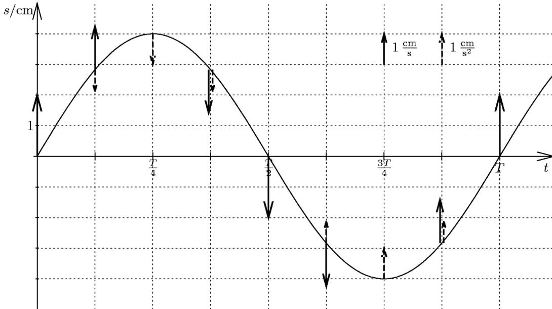
Geschwindigkeit und Beschleunigung sind jeweils als Vektoren dargestellt, die Beschleunigung gestrichelt. Die Einheiten für die Vektordarstellung sind angegeben. Es gilt  $v = \hat{v} \cos 2\pi \frac{t}{T}$  mit  $\hat{v} = \hat{s}\omega = 4 \text{ cm} \cdot 0,5 \text{ Hz} = 2 \frac{\text{cm}}{\text{s}}$ . Und  $a = -\hat{a} \sin 2\pi \frac{t}{T}$  mit  $\hat{a} = k\hat{s} = \omega^2\hat{s} = 4 \text{ cm} \cdot 0,25 \text{ Hz}^2 = 1 \frac{\text{cm}}{\text{s}^2}$ .
