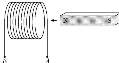
Wenn sich der Nordpol der Spule nähert, steigt der Betrag des magnetischen Flusses und an den Enden der Spule wird eine Spannung vom Betrag  $U_{\text{ind}} = n\dot{\Phi}$  induziert. Die Orientierung der Spannung bestimmen wir zur Übung auf zwei Arten,
