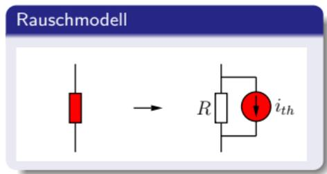
Rauschen wird mittels einer externen Gaußschen Stromquelle modelliert.
